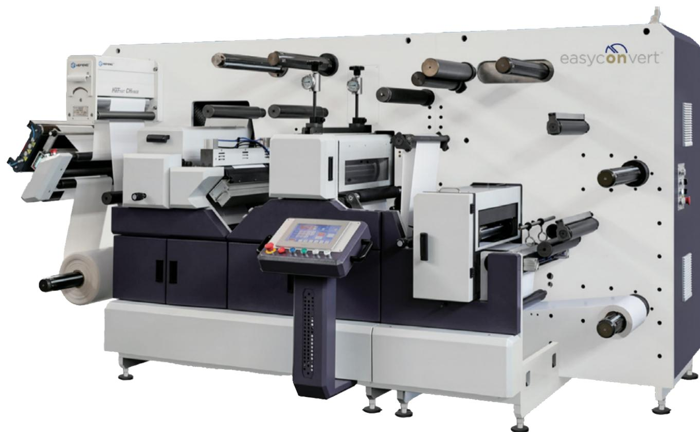
La **Easyconvert** est une machine de transformation / finition haute qualité et grande vitesse. Avec les possibilités suivantes : dorure à froid, super vernis, impression flexo rotative et semi-rotative, découpe rotative et semi-rotative, sortie et découpe IML, refente et mise en feuilles.
