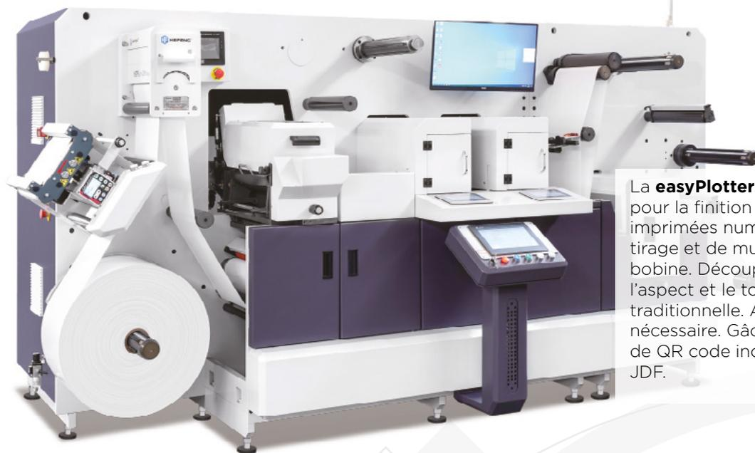
La **easyPlotters** a été spécialement conçue pour la finition de bobines d'étiquettes imprimées numériquement avec un très court tirage et de multiples travaux sur une même bobine. Découpe numérique identique sur l'aspect et le toucher d'une découpe traditionnelle. Aucun outil de découpe n'est nécessaire. Gâche de calage minimum. Lecteur de QR code inclus, préparé pour l'intégration JDF.
