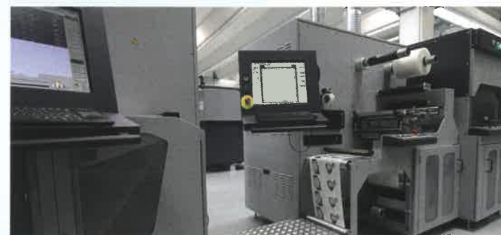
La presse Durst Tau 330 fonctionne ici en ligne avec les lignes LFS (découpe laser) ou EFS (découpe mécanique) conçues chez Smag.
