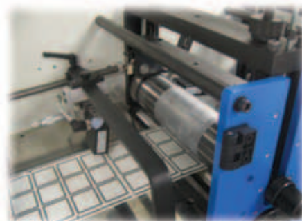
Unité de découpe semi rotative. Semi Rotary die cutting station.
