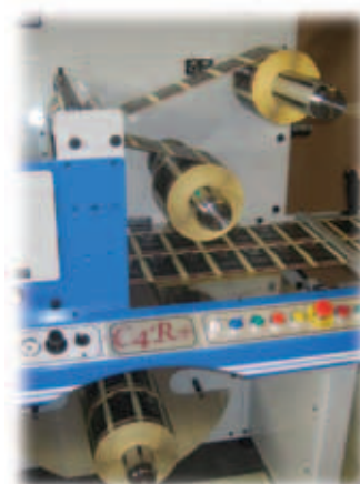
Rembobinage sur deux mandrins. Dual mandrel rewinding unit.
