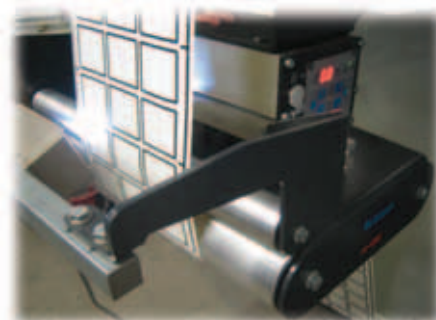
Guide de bande ultra son avec lecture de ligne. Web guide with printed line register system.
