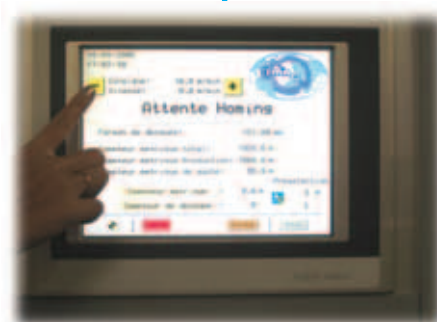
Écran tactile, contrôle découpe semi rotative. Die cutting station touch screen control.
